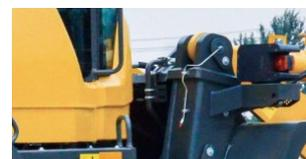
Todos os pontos de lubrificação são em posições de fácil acesso para facilitar a lubrificação da máquina. O operador pode ficar no solo enquanto estiver fazendo a manutenção de rotina.
