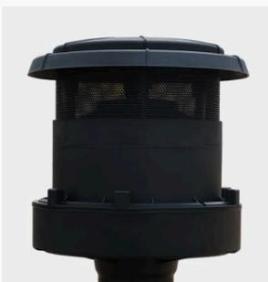
O sistema de admissão de ar do motor possui pré-filtro externo para melhorar a limpeza da admissão de ar, aumentando assim a vida útil do motor.
