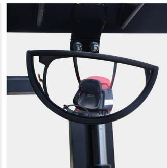
O espelho retrovisor panorâmico é usado para fornecer um campo de visão mais amplo para garantir uma condução segura
